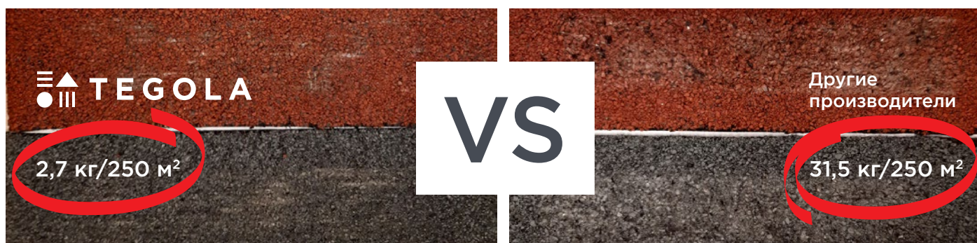
Образцы черепицы после испытаний Brush-Test
